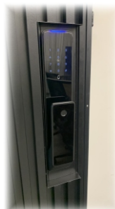
Exemplo de instalação ideal em porta ripada
