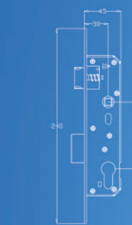
Máquina de porta de giro com 45mm de profundidade (M30G-POR/VE)
