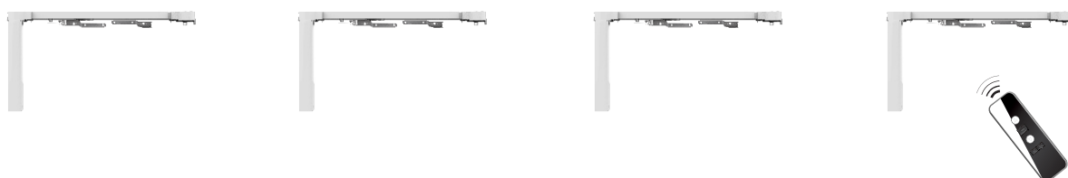
⑥ Único controle de um canal controlando 4 motores simultaneamente.
