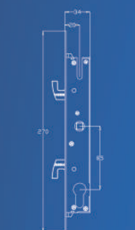
Máquina de porta de correr com 34mm de profundidade (M20C-POR/VE)
