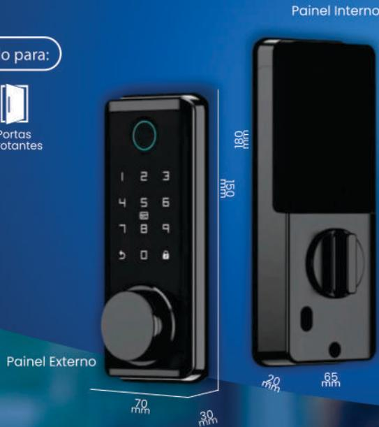
Fechadura de sobrepor em liga de zinco; máquina em aço inoxidável; biometria (até 50 digitais), senha numérica (até 150 senhas), Chave RFID (até 150 Tags) e chave de emergência (contém 2 unidades). Possui controle de acesso através de aplicativo TUYA. Compatível com gateway para gerenciamento de acesso via Bluetooth.
