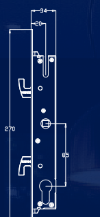
Máquina de porta de correr com 34mm de profundidade (M30C-POR/VIE)
