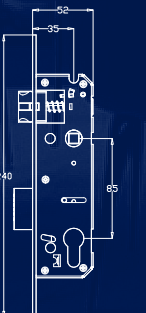
Máquina de porta de giro com 52mm de profundidade (M35G-POR/VIE)
