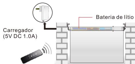
Por favor, retire o carregador da bateria depois de 4 horas com a bateria totalmente carregado.
